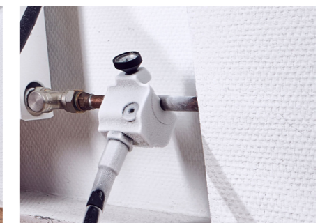
Kompaktna stezaljka za zamrzavanje omogućuje da se cijev zamrzne - čak i blizu zida
