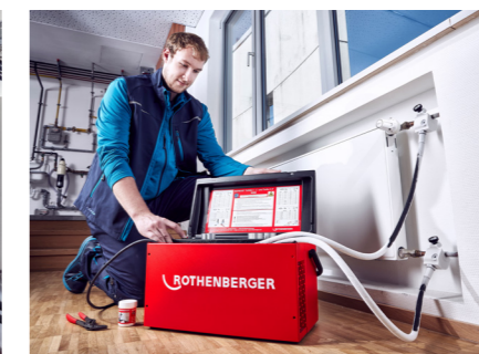
Postupak zamrzavanja započinje automatski nakon ugradnje hvataljki za zamrzavanje
