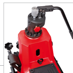
Hidraulični cilindar za fino određivanje dubine utora
